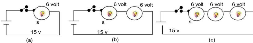
Bila saklar s ditutup, prediksi apa yang akan terjadi pada lampu yang ada pada rangkaian (a), (b), maupun (c) serta jelaskan mengapa demikian? (d) rancanglah suatu percobaan agar 3 buah lampu yang masing-masing tegangannya 6 volt yang dihubungkan dengan sumber tegangan 15 volt
